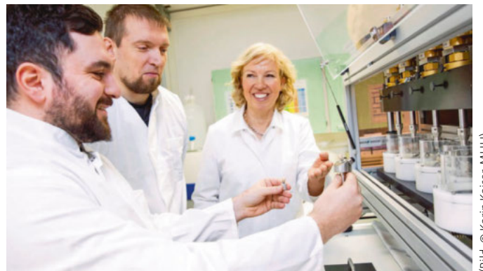
Osman Akbas (links), Dr. Andreas Greuling und Prof. Meike Stiesch testen die Belastbarkeit der Implantatmodelle am Kausimulator
